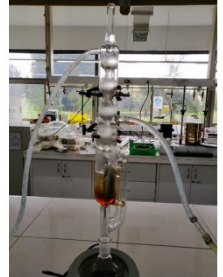
Figura 2: Equipo soxhlet, utilizado en el proceso de extracción.
